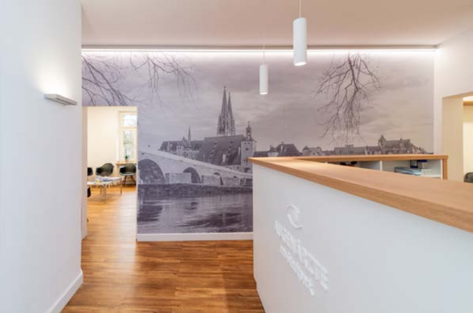
Abb.: Beim Betreten der Arztpraxis fällt der Blick auf das großformatige vier Meter lange beleuchtete Bild der Regensburger Altstadt. Dieses wird über eine durchgehende LED-Linie inszeniert. Passend zur LED-Linie wurde eine schwenkbare Wandleuchte mit Direkt-/Indirektbeleuchtung konstruiert.
