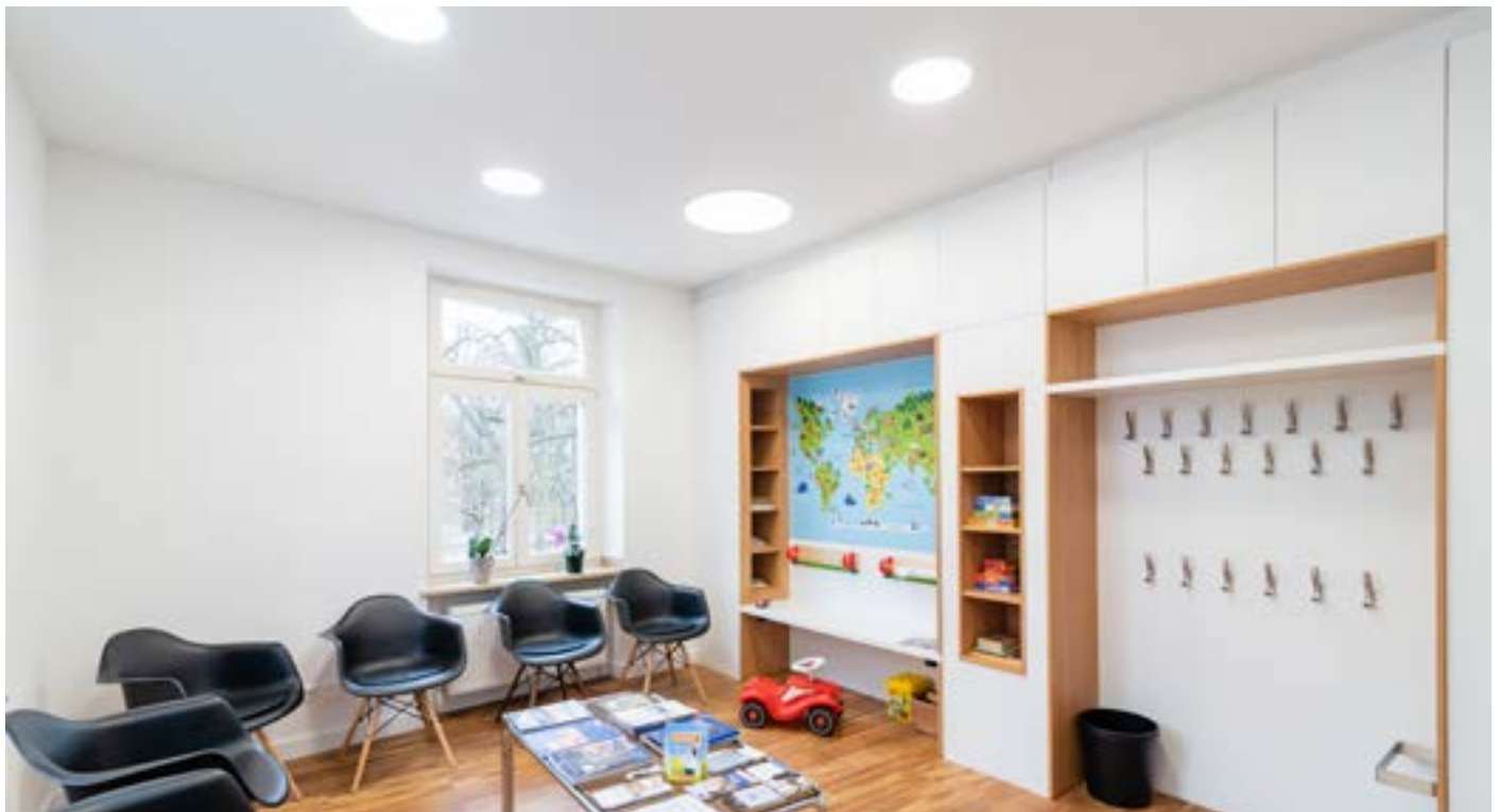
Abb.: Die mittlere Beleuchtungsstärke im Wartezimmer beträgt 390 lx. Durch diesen bewusst höher als nach Richtlinie gewählten Wert, passen sich die Augen schon im Wartezimmer auf die bevorstehende Untersuchung in den Behandlungsräumen an.
